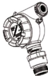
Датчик, установленный прямо на преобразователе
