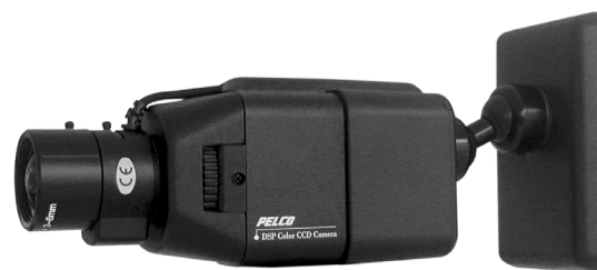
ТЕЛЕКАМЕРА УСТАНОВЛИВАЕТСЯ НА УЗЛЕ КРЕПЛЕНИЯ РСМ100
