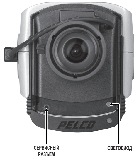
ВИД СПЕРЕДИ, ТОЛЬКО ТЕЛЕКАМЕРА (ОТКРЫТО, ЧТОБЫ ПОКАЗАТЬ СЕРВИСНЫЙ РАЗЪЕМ)
