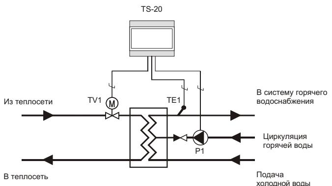
**Пример регулирования системы горячего водоснабжения на базе котла или аккумулятора теплоэнергии**
