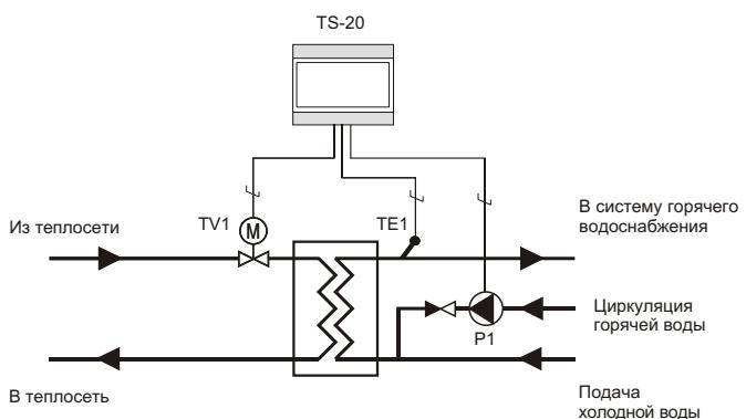
**Пример регулирования системы горячего водоснабжения, подключенной к теплосети через двухступенчатый теплообменник**
